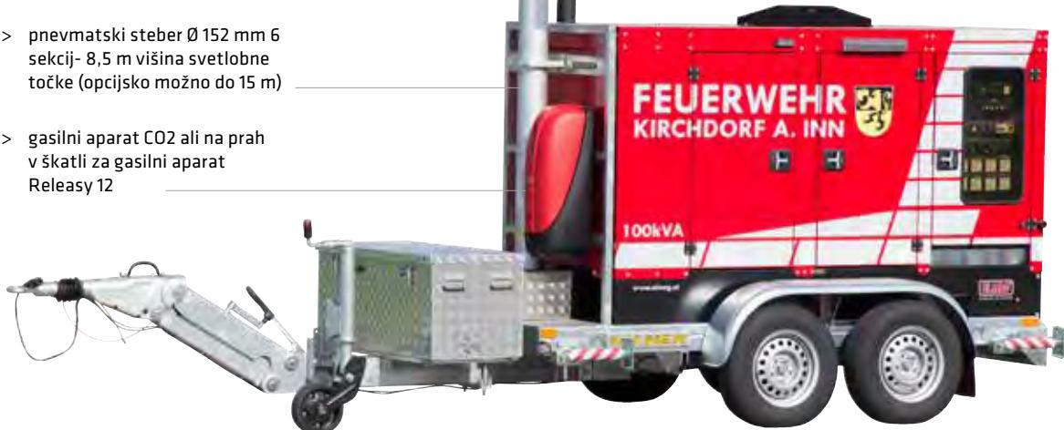
**MBNA 100WDE s pnevmatskim stebrom & mehanizmom za vrtenje & obračanje**
