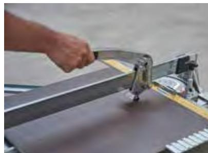
Najpomembnejše pri ročnih rezalnikih ploščic: trdota in polmer rezalnega kolesa.
