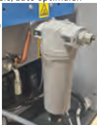
Predfilter neposredno na sušilniku zraka(samo pri verziji DF)
