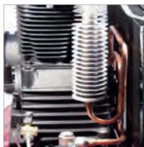
Hladilnik iz aluminijastega tlačnega litja in bakrena hladilna cev
