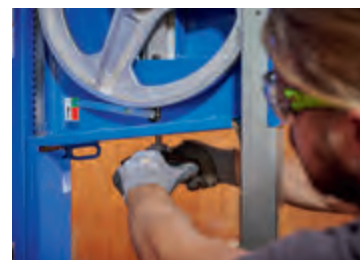
Menjava traku žage v najkrajšem možnem času. Stroj se ustavi takoj, ko se odprejo vrata.
