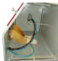
notranjost PAL (injektorski sistem)
