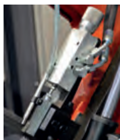
hidravlični nadzor pritiskne sile pri modelih DGH
