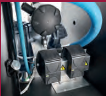
gretje zvočno izoliranega pokrova: za naprave pri nizkih temperaturah okolice
