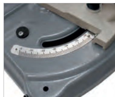
Dobro čitljiva kotna skala - preprosta nastavitve kota od 0 do 60°
