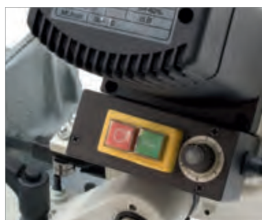
Brezstopenjsko nastavljiva hitrost rezanja z regulatorjem SGR
